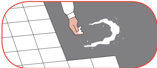
1. El tipo de pieza a colocar en el suelo. Si las piezas tienen una porosidad media/baja no será suficiente el espolvoreo con cemento sobre la chapa de mortero. Se deberán utilizar productos específicos.
